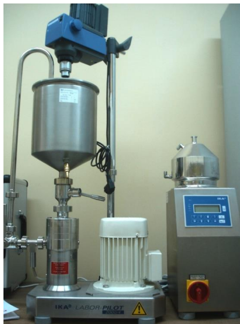
Homogenizator mechaniczny 12-stopniowy z by-passem, chłodzeniem zasobnika, chłodzeniem głowicy homogenizującej i dodatkowym mieszadłem ramowym z teflonowymi zgarniakami (IkaPol, Warszawa)
