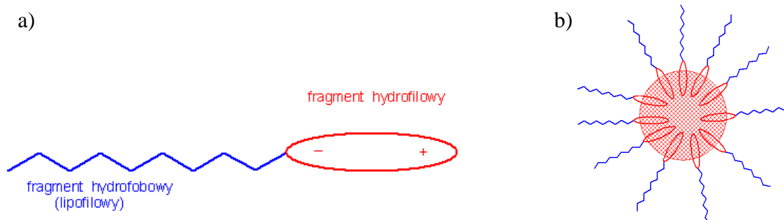
Rys. 1. a) schemat budowy cząsteczki emulgatora, b) micela emulsji W/O
