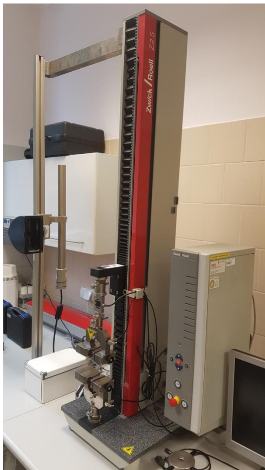
Zwick/Roell Z 2.5 -Uniwersalna maszyna wytrzymałościowa (Zwick/Roell, G)
