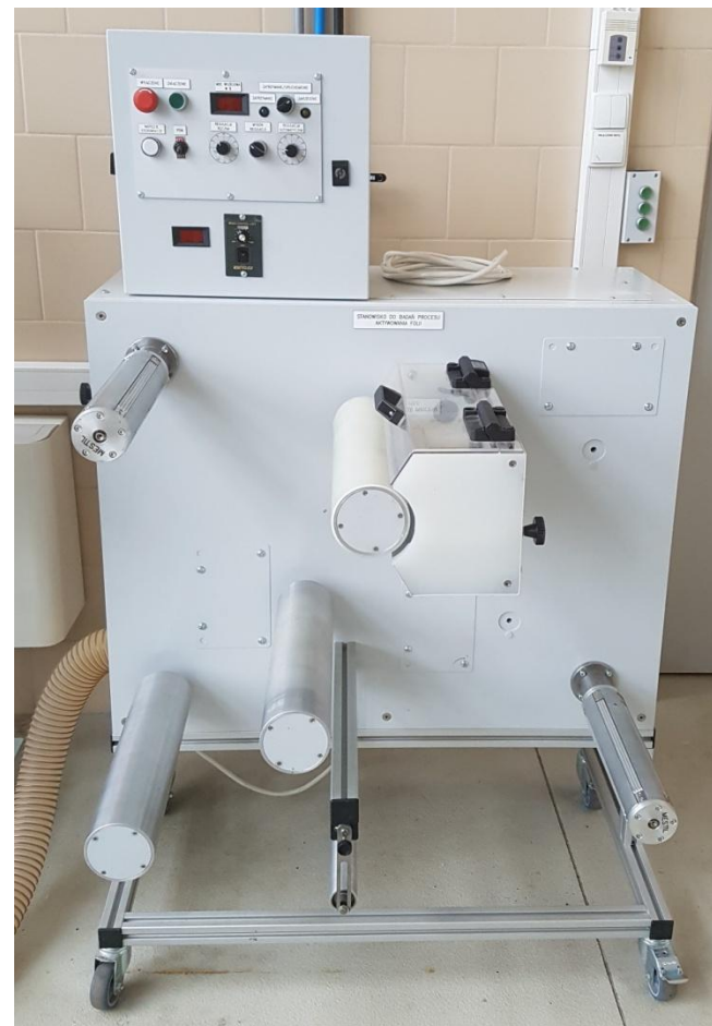
Stanowisko do aktywacji koronowej folii płaskiej (IMPIB, PL)
