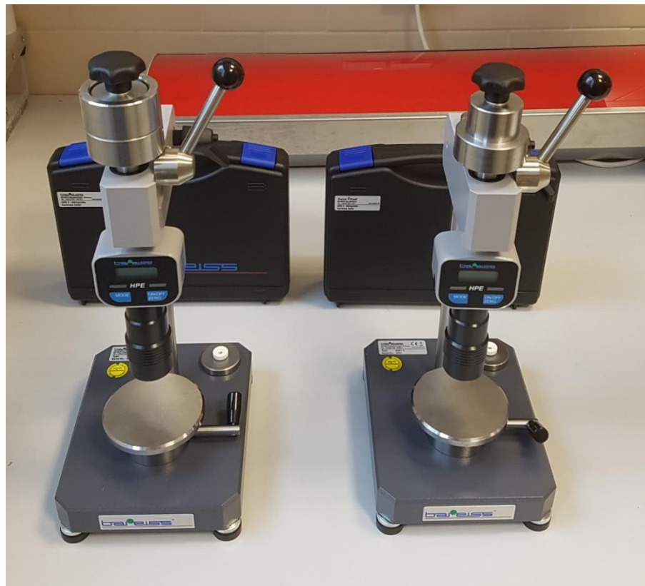
Twardościomierze w skali Shore'a: A oraz D (Bareiss, G)
