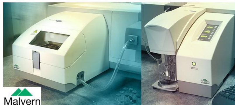
Mastersizer 2000 - określanie wielkości cząstek Malvern (UK)
