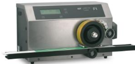
IGT F1 – tester zadrukowalności (flexo- i rotograwiurą)
