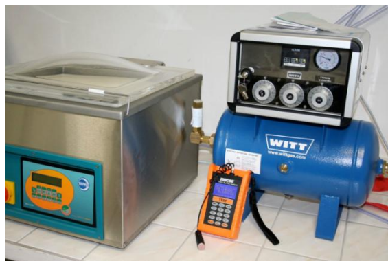
Modyfikowana atmosfera O 2 , CO 2 , N 2 - pakowanie MAP i monitorowanie zmian składu gazów + PackCheck (Moccon, USA)
