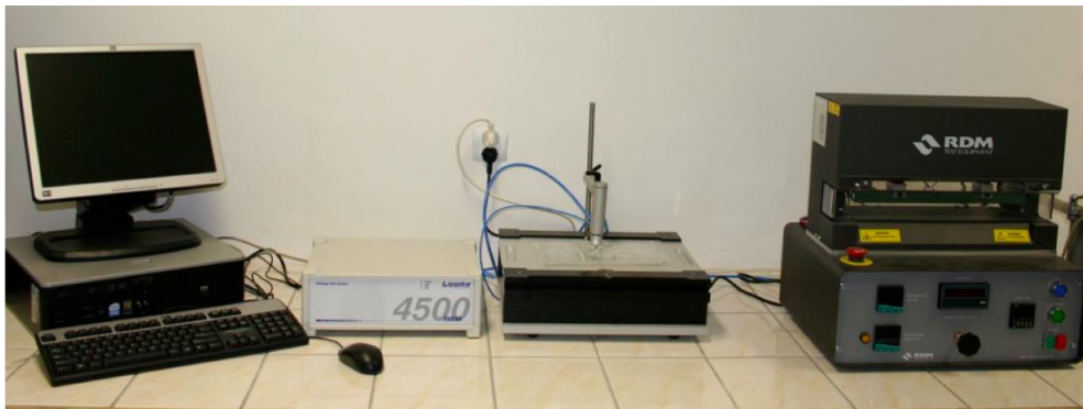
HSE-3 HEAT SEALER (RDM, UK) 4500SL - szczelność i siła zgrzewu (Lippke, D)
