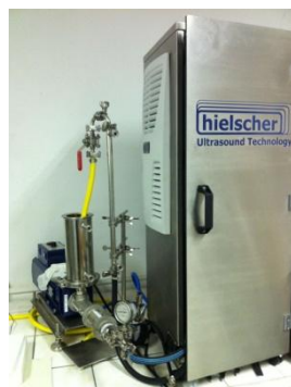
US generators (400 and 1000W) with flow cells - Hielscher (D)
