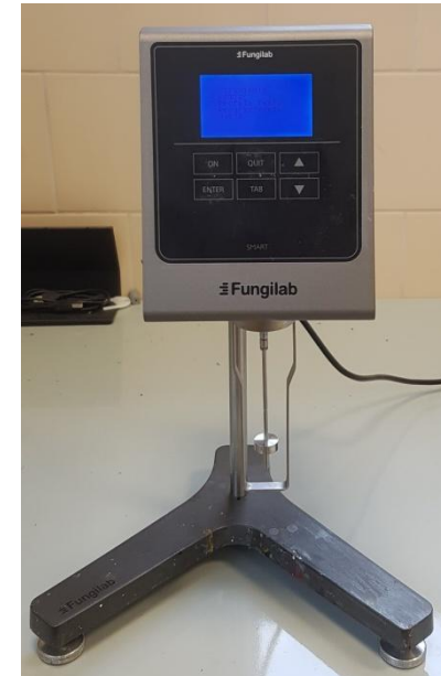
Wiskozymetr do badania lepkości wg Brookfielda (Fungilab)
